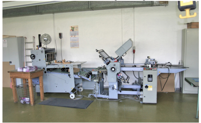
Falzmaschine T52/4 und Stehendbogenauslage
