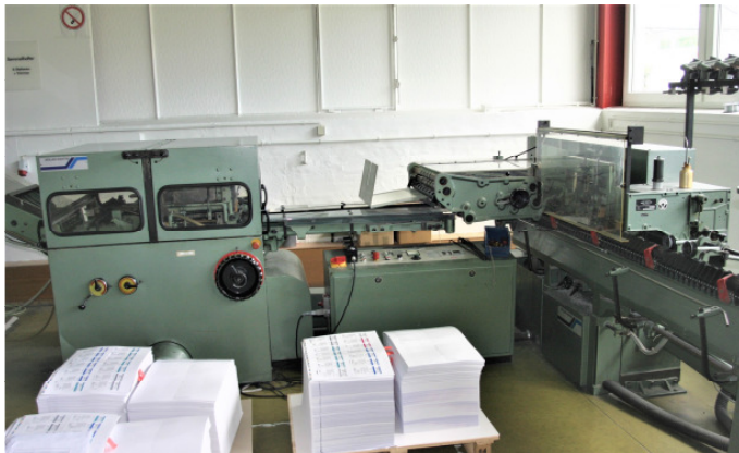
Dreischneider Typ 890, Sammelheftmaschine Typ 235
